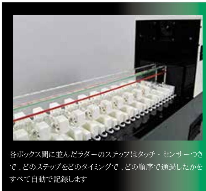
各ボックス間に並んだラダーのステップはタッチ・センサーつきで、どのステップをどのタイミングで、どの順序で通過したかをすべて自動で記録します
