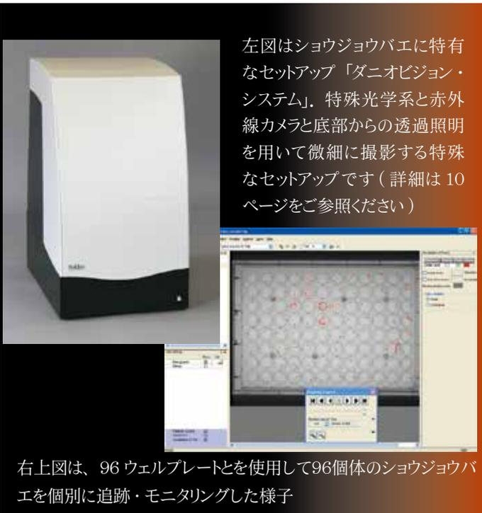
左図はショウジョウバエに特有なセットアップ「ダニオビジョン・システム」、特殊光学系と赤外線カメラと底部からの透過照明を用いて微細に撮影する特殊なセットアップです（詳細は 10 ページをご参照ください）
