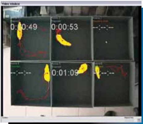
マルチアリーナ・モジュールの追加による、6つのケージ使用マルチチャンネル実験例
